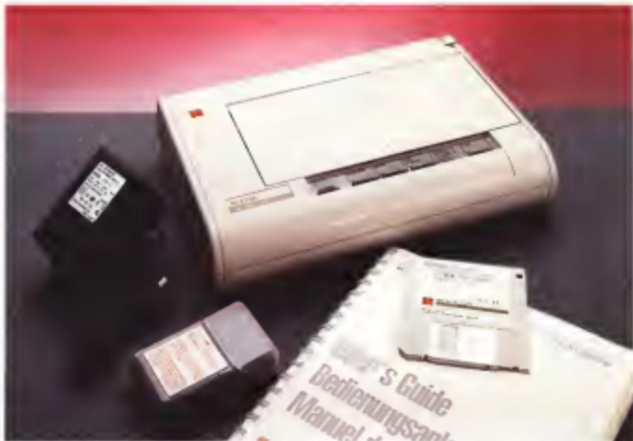
dalla presenza sul piano superiore di un piano ribaltabile, che svolge la funzione di vassoio per l'alimentazione della carta, e di un pannello di controllo composto da quattro tasti, un interruttore di alimentazione a sitta e otto spia luminose.
